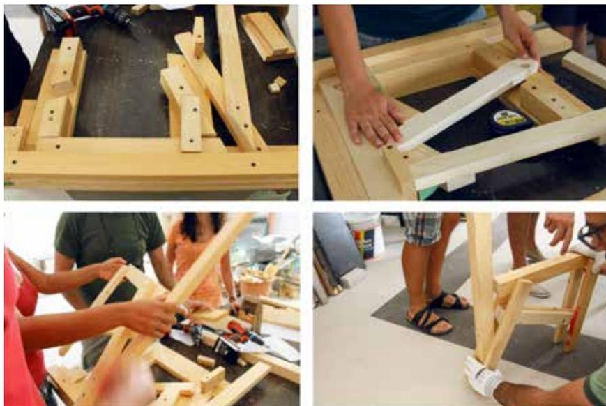
*Le tecniche di montaggio: la dima. Creare dei sistemi che semplificano la fase di montaggio*
